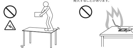
△注意 耐荷重量以上の物を載せないでください。物の落下や製品の変形により、けがをすることがあります。
