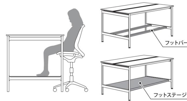
※ベンチテーブル連増セットにフットバー・フットステージを取付ける場合には、「連増用取付金具」を手配してください。以下のように取付ができます。
