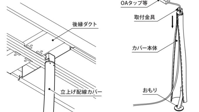
ケーブルを立ち上げ配線カバーで覆い、取付金具を後縁ダクトのスキマに引っ掛けてください。
