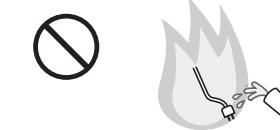
△警告 電源コードを束ねた状態で使用しないでください。コードが過熱して火災の原因となります。電源コードは必ず伸ばした状態でご使用ください。
