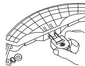
②電源プラグを脚フックのスリットへ差し込む
