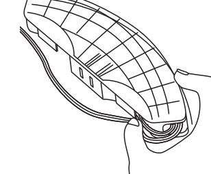
③ケーブルを脚フックのスリットへ差し込む
